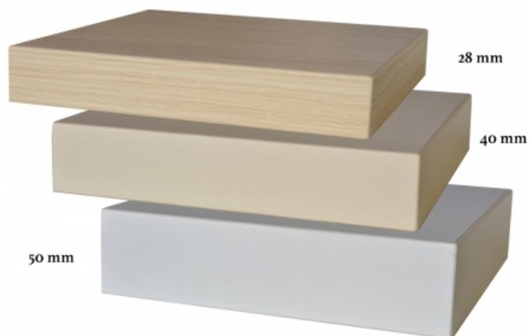
Plateaux stratifiés sur base d'aggloméré en épaisseur 28 mm et en médium pour les épaisseurs 40 et 50 mm, contrebalancé en blanc, chants PVC - épaisseur 2 mm - Disponible en décors de la gamme standard
